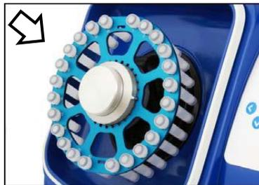
3. 将指形压板拧到圆形转盘上，当指状头接触到管盖时，再顺时针拧 1/8 圈即可，切勿拧太紧！
