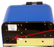
**警告：**如果实际提供的电压高于仪器开关所选择的电压，将对本仪器造成不可逆的损害，本公司不负责此类保修。
