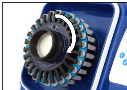
4. 将指形压板上的中心锁处的开关按至“锁定”状态。
